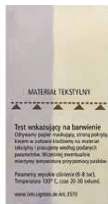
Widoczne zafarbowanie, duża ilość wolnych pigmentów na powierzchni. Konieczne użycie folii blokującej, np. FlexCut 588 Optima.
