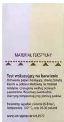
Lekkie zafarbowanie, mała ilość wolnych pigmentów na powierzchni. W zależności od jakości, możliwe użycie folii wymagającej niskiej temperatury (FlexCut X4 może blokować pigmenty).
